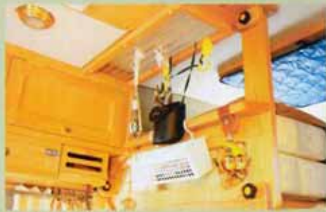
●子供たちがバンクベッドから落ちたので、取り外し可能な柵を取り付けた。そこを活用して手すりも増設。温泉宿仕様のタオル掛けも大活躍
