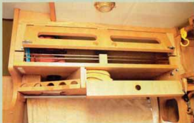
●もう一方のキャビネットは、中が見えの扉にした。下部には収納棚を増設。左側にリヤエアコンの吹き出し口を確保し、うまくデザインしている
