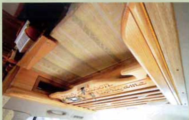
●バンクベッド下部の空間を活用して収納スペースを作った。扉は自作。底は箱子状になっており、何が入っているかはすぐ分かる
