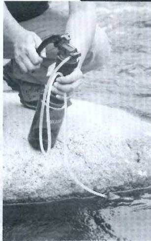
●MSR/ミニワークスEXはポンプ式に水をくみ上げ、接続したボトルやウォーターバッグにろ過の済んだ水をためる。フィルターは現場でクリーニングも可能。MSR/マイオックス浄水器は浄水器上部に塩と水を入れ、電気を通すことでオキシダント液（オゾン水）を作り、未処理の水に加えることで殺菌を行なう。殺菌効果は塩素の約2倍、O-157のほか、ヨウ素でも殺せないウイルス類も殺菌することができる
