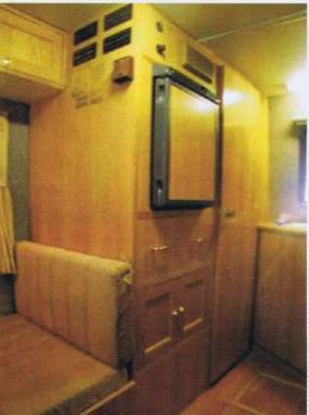
冷蔵庫はキャンプスタイルに合わせて容量を小さくして、空いたスペースを収納庫に変更。使い勝手に合わせて作り直せるのもいい。キッチン前のフロアには床下収納庫を作成した
