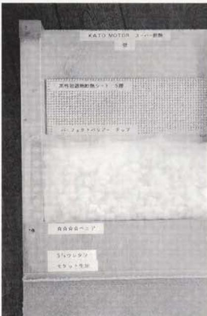
●壁面の加工も、基本的にルーフと同じ。パーカークトバリアがロールシートではなく、切り刻まれたチップ素材になっている
