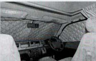
●6層ラミネートを含む全7層軽量断熱超音波キルトシートのマルチシェードは、助手席部に小窓が付いて使い勝手がいい
