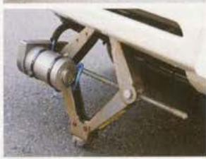
●車体を安定させるために前後に電動ジャッキを装備。リヤは既製の輸入品だが、フロントはバントジャッキにモーターを組み込んだオリジナル品。簡易的だが機能性は十分にある
