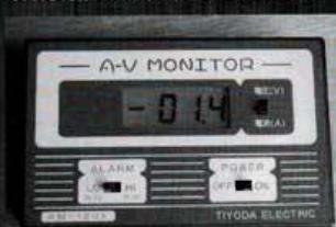
●電気消費量を量ると1.4A使用。8時間使用しても11.2Ahなので、サブバッテリー容量だけで十分対応する。©ニュージャパンヨット ☎0548-54-0221
