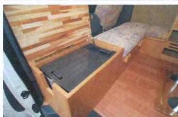
●無理にシートを設けていないので、これだけ大きな上開き式冷蔵庫が備えられた。シンク同様車外からのアクセスが容易だ
