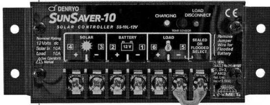
●PWM方式を用い、効率的にバッテリーが充電されるよう制御してくれる。ソーラーパネルからの入力電流10A、電圧25Vまで。バッテリーの保護回路を内蔵しており、10Aの消費電流まで対応。シール型、補水型の選択ができるので、対応できるサブバッテリーも多い
